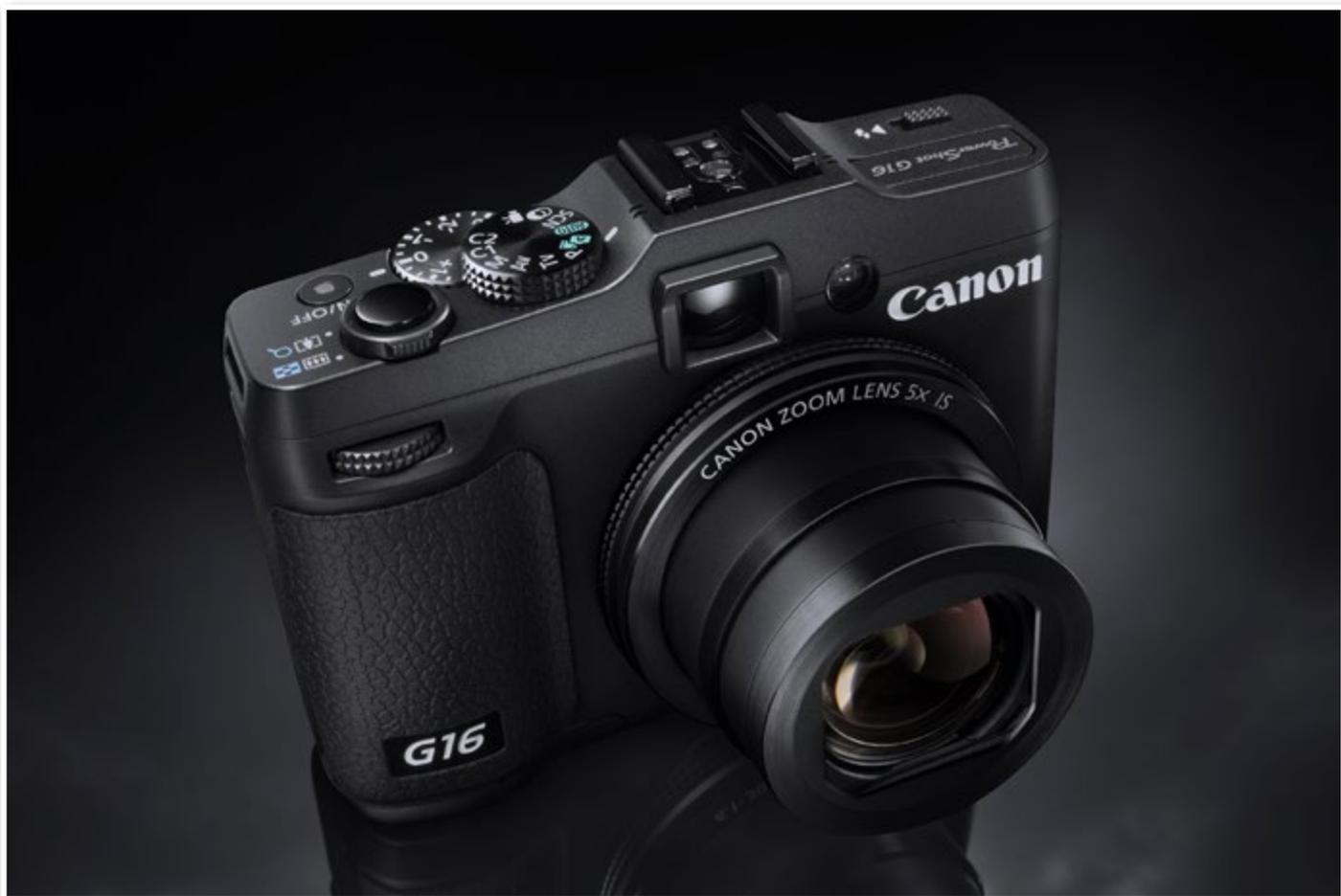
Dispone de estabilizador de imagen incorporado de hasta cuatro puntos, lo que supone una gran ayuda, junto con su luminosa óptica, para tomas en condiciones de poca luz y sin tener que subir en exceso el ISO (que podremos aumentar en esta ocasión hasta 12.800).
