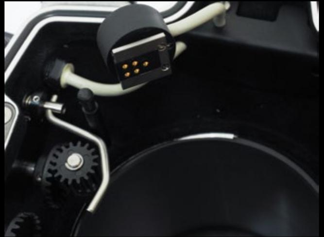
*Zapata conexión flashes externos*
