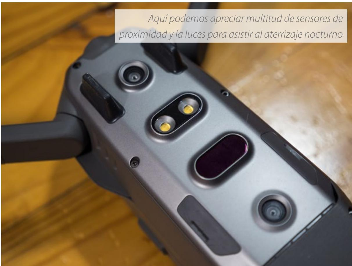
*Aquí podemos apreciar multitud de sensores de proximidad y la luces para asistir al aterrizaje nocturno*
