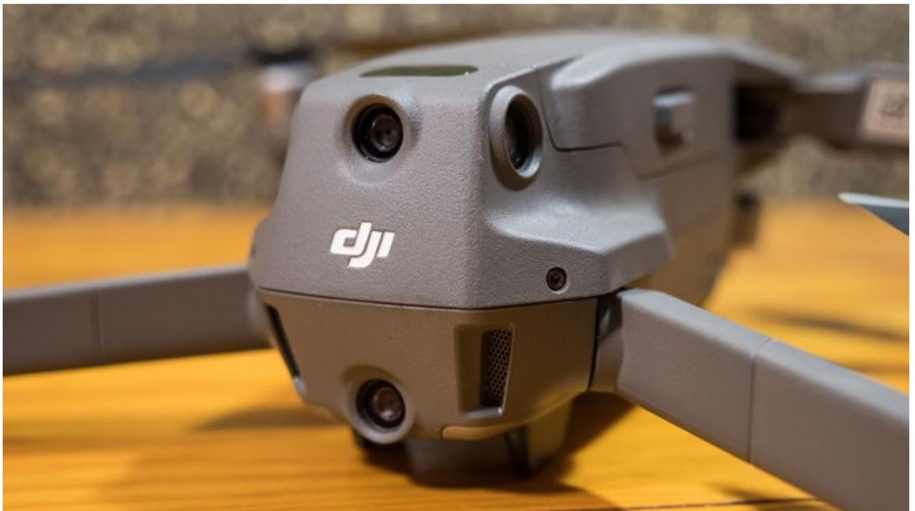
*Este dron está completamente rodeado por sensores para evitar cualquier obstáculo en 360 grados*
